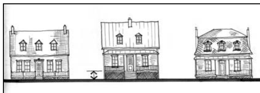
Des fondations trop hautes brisent le rythme des constructions.
